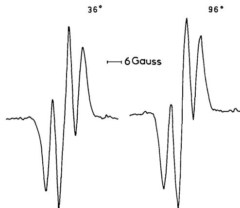
Fig. 4. Rotation du cristal autour de l'axe ternaire perpendiculaire au champ magnétique. Répétition du spectre tous les  $60^\circ$  pour n'importe quelle position initiale du cristal.
